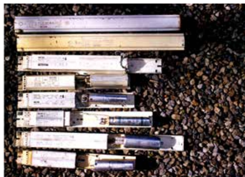
Fig. 1b Alimentatori capacitivi dell'azienda Knobel, Ennenda. Gli stessi apparecchi della fig. 1a dopo la rimozione della copertura dei condensatori. Lunghezza (apparecchio superiore): 40,7 cm
