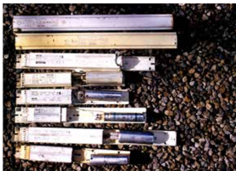
Abb. 1b: Kapazitive Vorschaltgeräte der Firma Knobel, Ennenda. Dieselben Geräte wie in Abb. 1a nach dem Entfernen der Kondensatorenabdeckung. Länge (oberstes Gerät) = 40,7 cm
