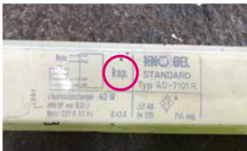
Bezeichnung «kap.» deutet auf die Anwesenheit eines Kondensators (kapazitiver Teil) hin.
