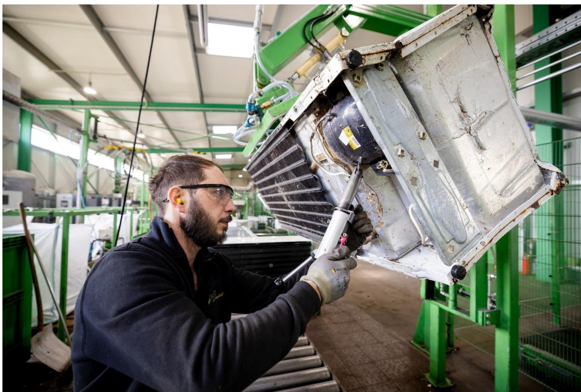
Première étape du processus de recyclage: les agents réfrigérants sont aspirés hors des appareils de réfrigération.
